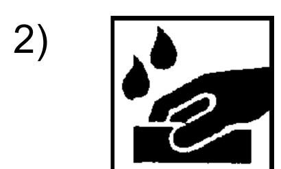
Schleifen mit Scotch Brite Typ S ultra fine Rub down with Scotch Brite Typ S ultra fine Poncer avec Scotch Brite Typ S ultra fine
