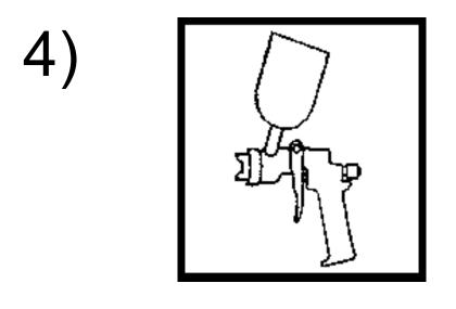
Grundieren mit Sikkens 2K-PP/EPDM-Primer oder PUR-Primer Prime with Sikkens 2K-PP/EPDM-Primer or PUR-Primer Apprêter avec 2K-PP/EPDM-Primer ou PUR-Primer
