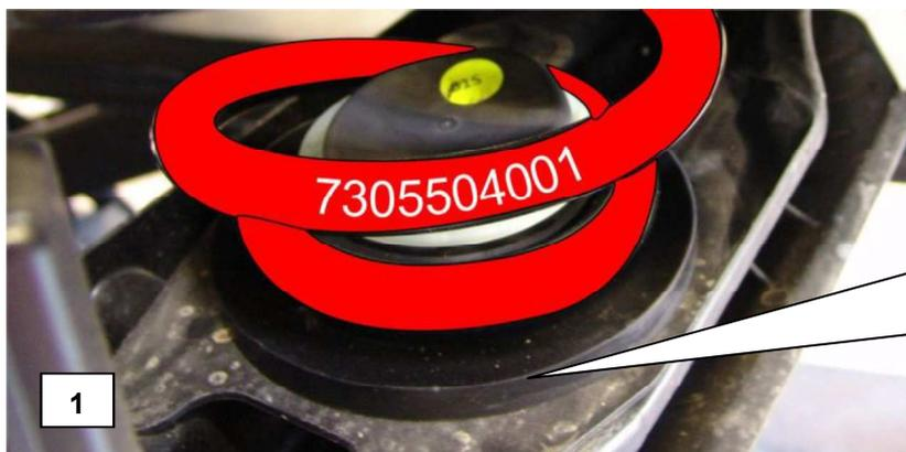
Der mitgelieferte Feder-teller M45-85-062-01-01 wird an der Hinterachse unten angebracht.
