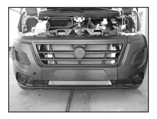
Am unteren Querträger müssen die U-Scheiben eingesetzt werden. Falls ein Modell mit kompletten Spritzschutz verbaut werden muss, werden die U-Scheiben nicht eingesetzt.
